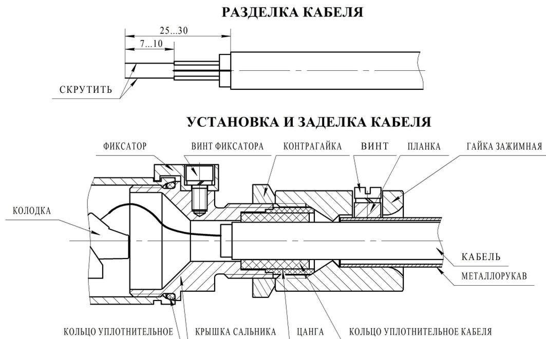
Оголенная жила многожильного проводника скручивается для удобства размещения провода в контактном гнезде. Диаметр провода, вставляемого в контактное гнездо, должен быть не менее 0,5 мм и не более 1,5 мм.
