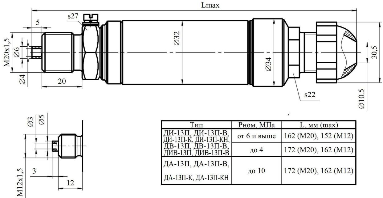
с прямым металлическим (ПММ) сальниковым вводом и гайкой под металлорукав
